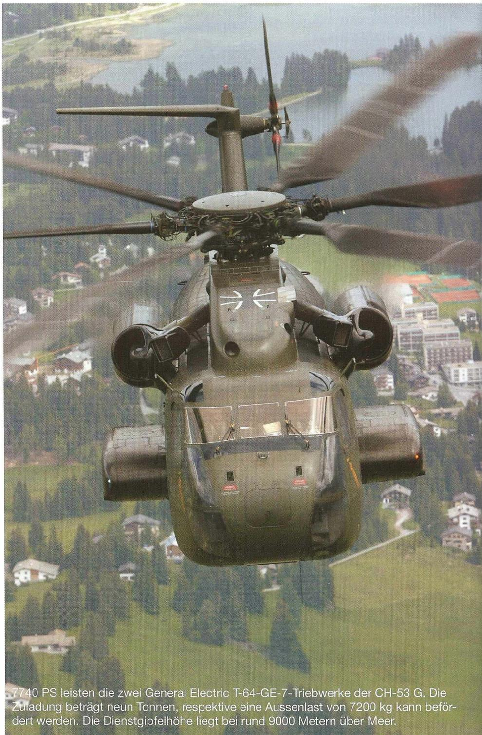
7740 PS leisten die zwei General Electric T-64-GE-7-Triebwerke der CH-53 G. Die Zuladung beträgt neun Tonnen, respektive eine Aussenlast von 7200 kg kann befördert werden. Die Dienstgipfelhöhe liegt bei rund 9000 Metern über Meer.
